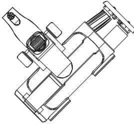
El rodillo con cepillo doble motorizado puede ser limpiado estirando el eje del rodillo con cepillo por un lado, usando el dedo pulgar y el dedo índice.
