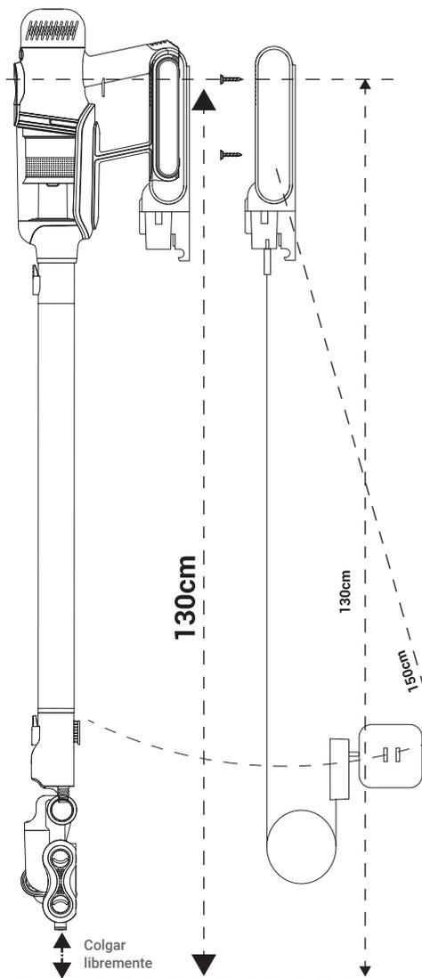
Este montaje de pared requiere de un agujero en la pared usando tornillos de expansión. Favor verifique su lista de empaque para esta configuración y tornillos.
