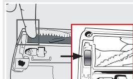
Se il dispositivo di blocco non si chiude, il rullo spazzola non è stato correttamente inserito.
